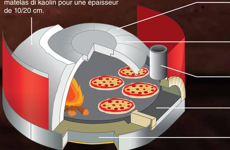
Masticage entre les segments de la voûte et entre le plan de cuisson et les segments, en ciment plastique réfractaire de haute résistance.
